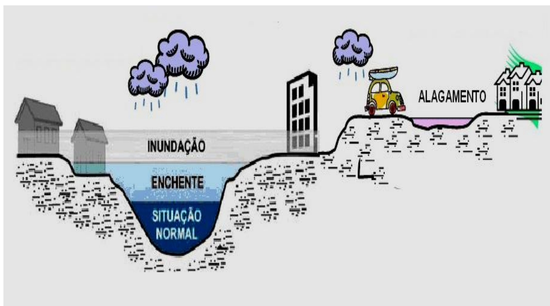
FIGURA 3- Inundação, Alagamento e enchente
